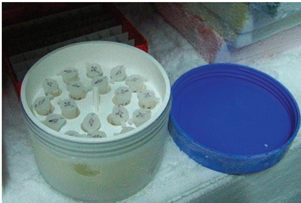
Foto 2. Tubos Eppendorf dentro de MrFrost-NALGENE® dentro de la cámara fría a -86^{\circ}\text{C} .
